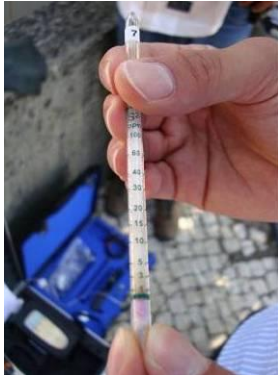
Kits e tubos colorimétricos para medição de sulfuretos e sonda multiparamétrica para medições in situ da massa líquida.
