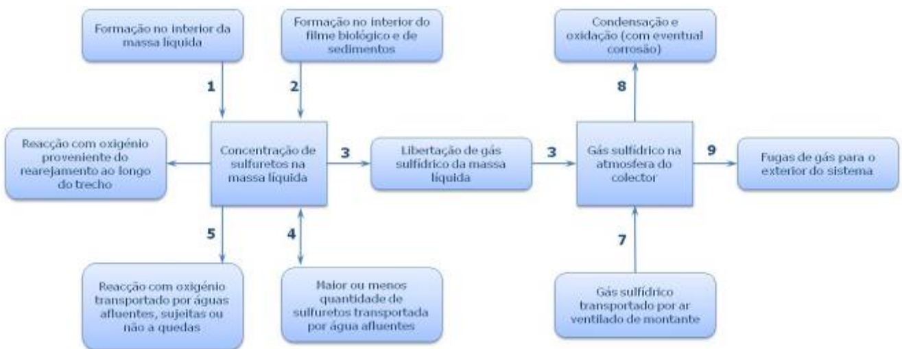
Figura 5.9 – Interações e principais factores que intervêm no balanço de sulfuretos no interior da massa líquida e no balanço de gás sulfídrico na atmosfera de coletores (adaptada de MATOS 1992).
